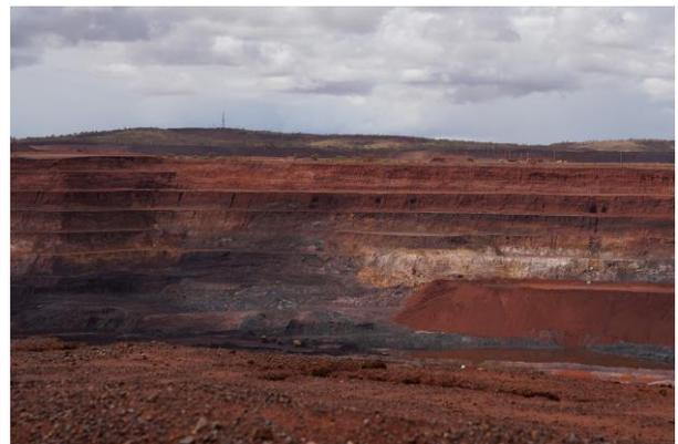
**Abbildung 36: Blick in einen Tagebau mit Innenkippe**
