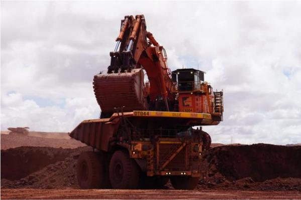
**Abbildung 39: Ladezyklus mit Tieflöffelbagger und SKW**
