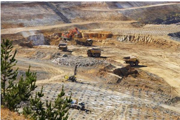
**Abbildung 25: vorne: Bohren und Besetzen von Sprengbohrlöchern; hinten: Laden und Fördern**
