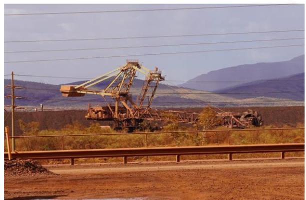
Abbildung 20: Schaufelrad-Reclaimer vor einer Längshalde des Lagerplatzes
