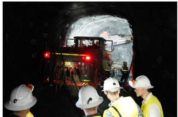
**Abbildung 54: Bohrwagen beim Setzen von Gebirgsankern und Verzugsmatten zur Gebirgssicherung**
