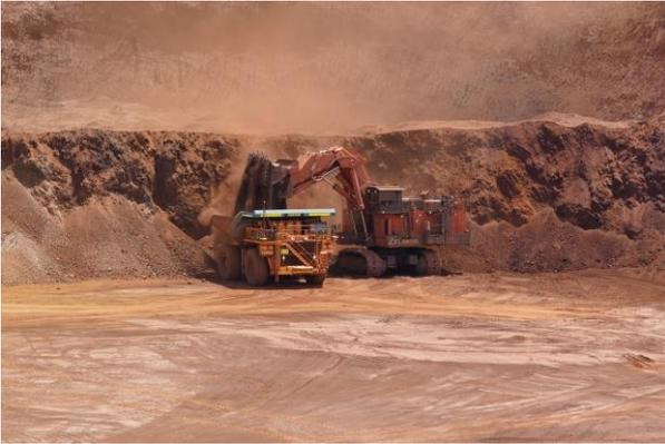
Abbildung 14: Ladespiel eines SKW und eines Hochlöfelfbaggers
