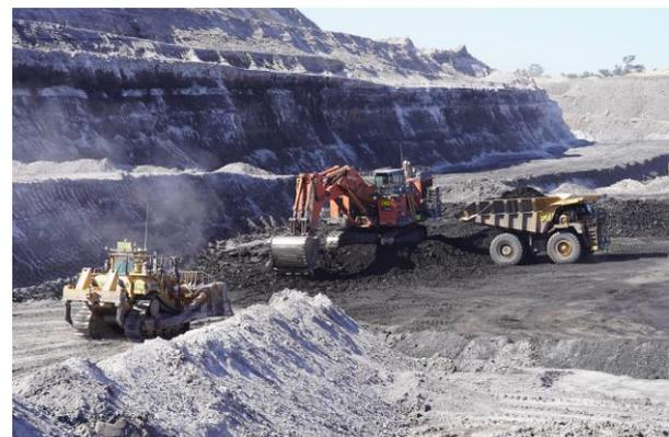
Abbildung 30: Gewinnung des Kohleflözes mit Hydraulikbagger, SKW und Raupe
