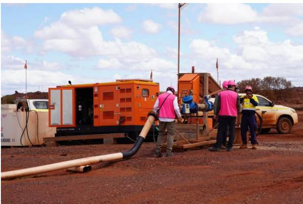
**Abbildung 37: Pumpstation zur Tagebausümpfung**
