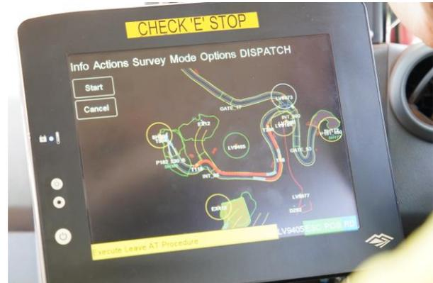
**Abbildung 13: Bedieneinheit des Kollisionsvermeidungssystems des autonomen Transportsystems**
