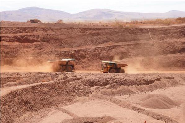
Abbildung 15: Autonom fahrende SKW auf dem Weg zur Lade- bzw. Kippstelle
