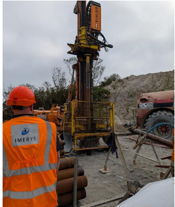
Kernbohrung im Rahmen der Exploration des ehemaligen Tagebaus
